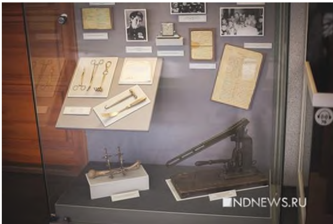
Рис.5. Машина для таблетирования стрептоцида
